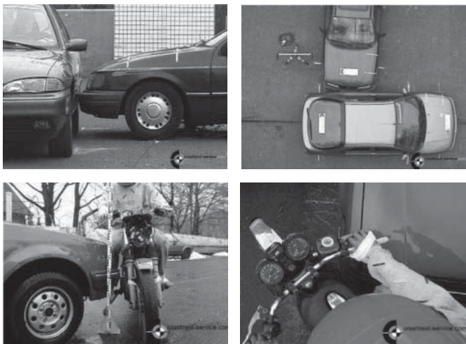
Bild 13: Beispiele für Anstoßkonfiguration von auftragsmäßig durchgeführten Crashtests. © crashtest-service.com GmbH, Münster, Deutschland, http://www.crashtest-service.com
