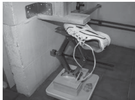
Bild 12: Belastungsprüfung an einem Sportschuh zur vergleichenden Bewertung der Sohlendeformation.
