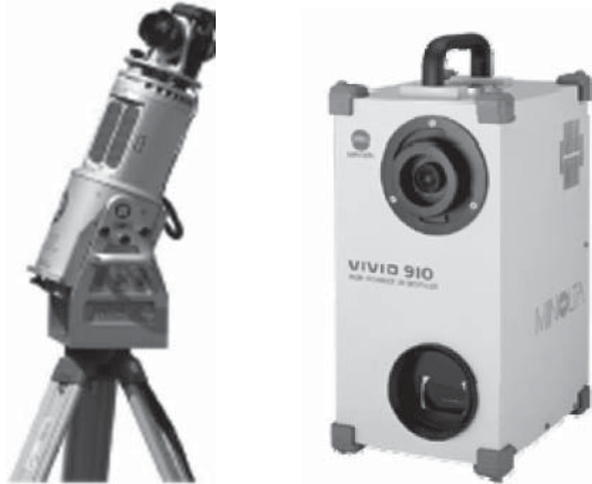
Bild 3: Riegl LMS-Z420i und Minolta VIVID 900/910 3D-Lasermessgeräte der TU-Wien.
