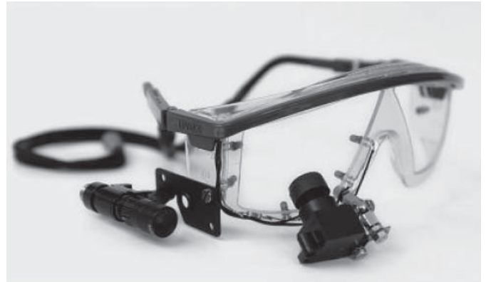
Bild 4: Messbrille zur Verfolgung der Augenbewegung und der Gesichtsfelderfassung, siehe [4].
