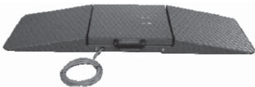
Bild 7: Transportable Radlastwaage System TPS „Professional“, Messbereich bis 10 kN, siehe [9].
