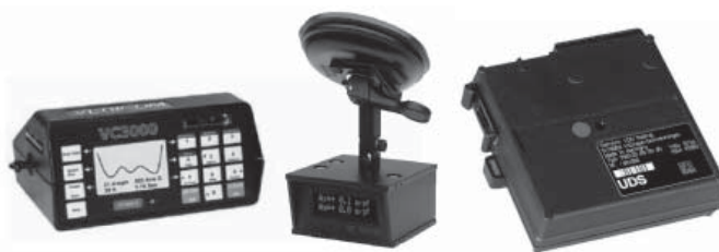
Bild 6: VC3000DAQ von Vericom [6], XL-Meter Pro Gamma von Inventure [7] und VDO-Kienzle Unfalldatenschreiber (UDS) [8].
