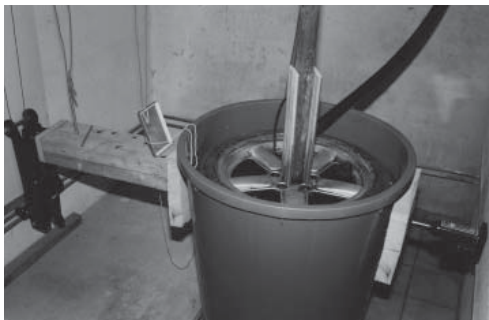
Bild 11: Versuchsanordnung zur Dichtheitsprüfung eines PKW-Rades in einem Wasserbad unter simulierter Betriebsbelastung.
