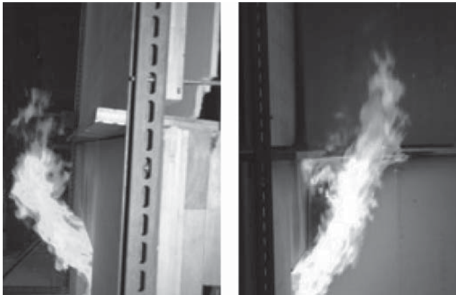
Abbildung 6: Flammenausbildung mit Brandsperre in der Fläche und in der Ecke
