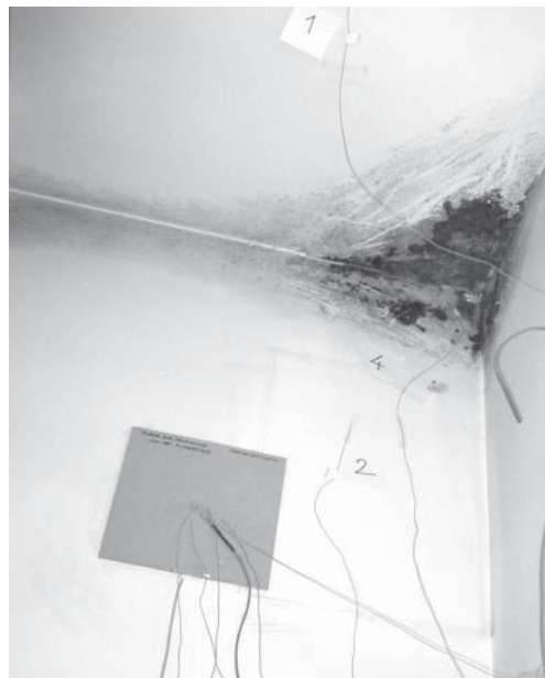
Abb 7: Wärmestrommessplatte an einer Außenwand
