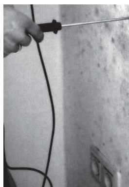
Abb 6: Messung der Oberflächentemperatur mittels Temperaturfühler
