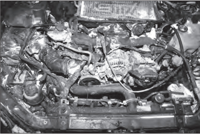
Abbildung 2: Brandausbruchsbereich im Motorraum des Rallyewagens Subaru WRX
