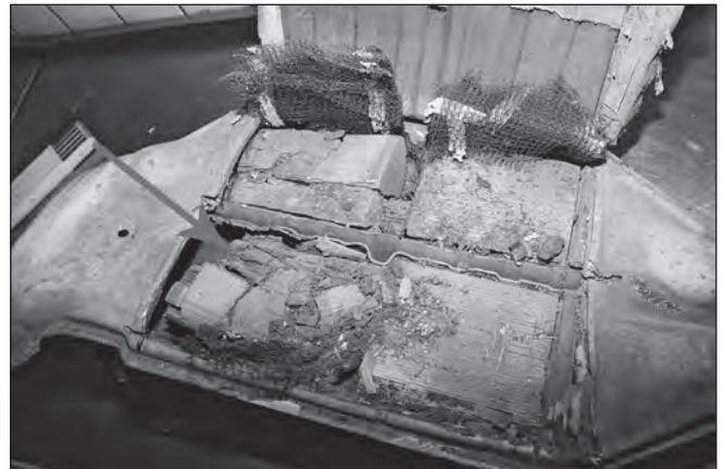
Abbildung 3: Geschmolzene Katalysator-Trägerkeramik des Mercedes Benz SL 500
