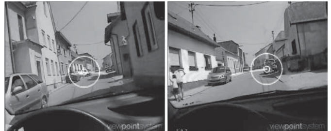
Abbildung 9: Screenshots des FPC-Ergebnisvideos: Kontrollblicke auf Fußgänger am linken (0,28 s) und rechten Fahrbahnrand (3 Blickzuwendungen mit einer Gesamtdauer von 3,08 s)
