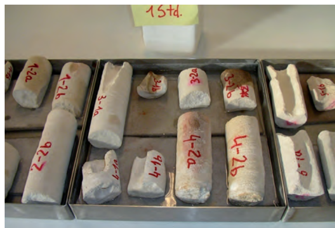
Abbildung 13: Wirksamkeitsüberprüfung der Injektionscreme am Objekt durch kapillare Saugversuche an Bohrkernen aus der Injektionsebene
