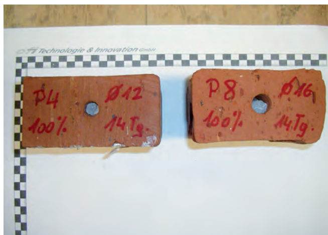
Abbildung 12: Wirksamkeitsüberprüfung der Injektionscreme im Labor an Mauerziegeln
