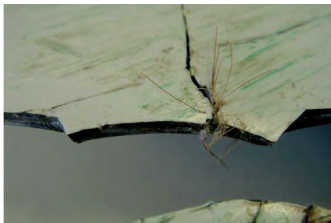
Abbildung 11: Haare auf einer vorderen Kunststoffstoßstangenverkleidung mit „aufglänzenden Stellen“
