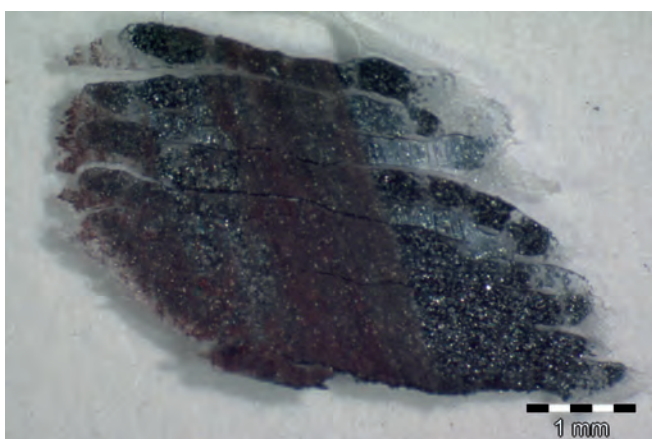
Abbildung 8: Vom Klagsfahrzeug isolierter roter Abrieb (mit Resten der originären Lackierung)
