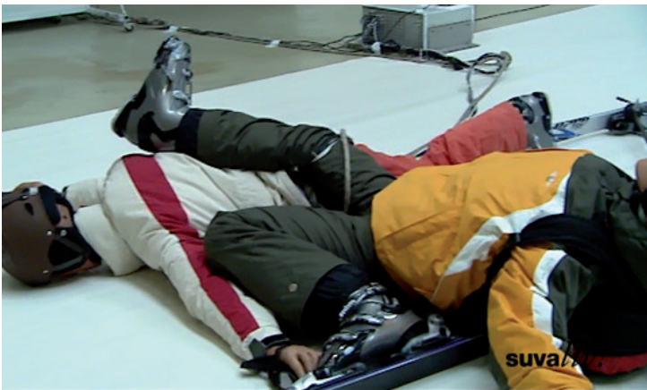
Abbildung 1: Endlagen einer simulierten Pistenkollision, wobei ein Schifahrer, von der Seite kommend, mit 50 km/h mit einem stehenden Schifahrer kollidiert; links: Laborversuch mit Crash-Test-Dummys (Bildquelle: SuvaLiv, Schweiz); rechts: MKS-Simulation
