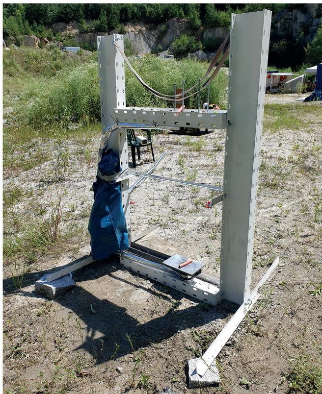
**Abbildung 7:** Versuchsaufbau mit Druckmessdosen zur Ermittlung der Rückstoß- und Aufprallenergie
