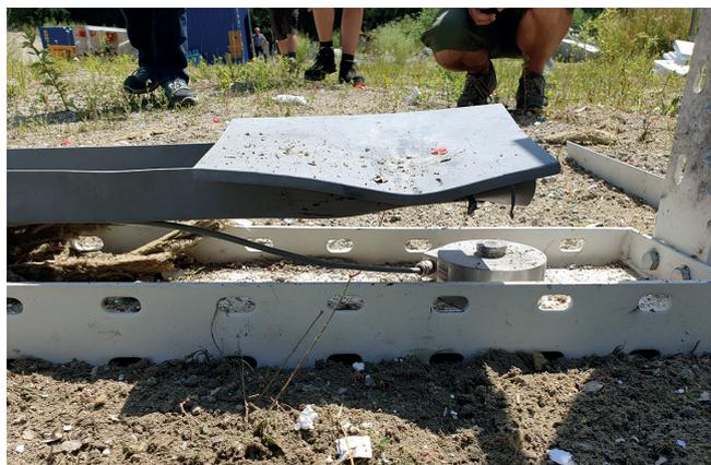
**Abbildung 9:** Ergebnis nach der Versuchsdurchführung: Zerstörte Versuchsanordnung durch hohe Rückstoßenergie
