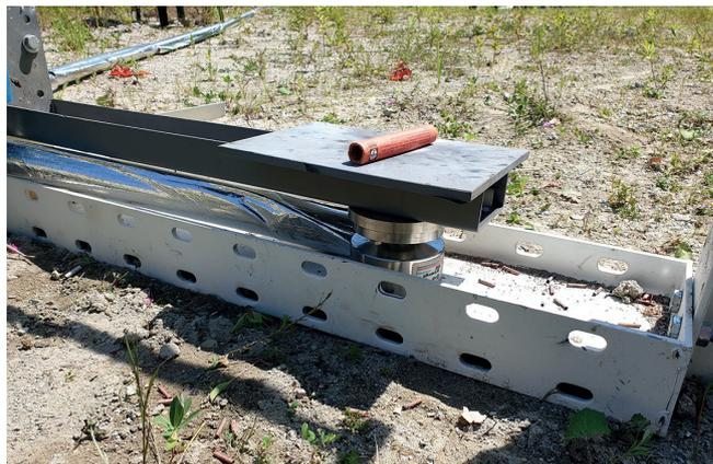
**Abbildung 8:** Versuchsanordnung für Ermittlung der Rückstoßenergie
