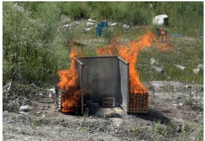
**Abbildung 12:** Versuch der thermischen Beanspruchung einer Schusskiste
