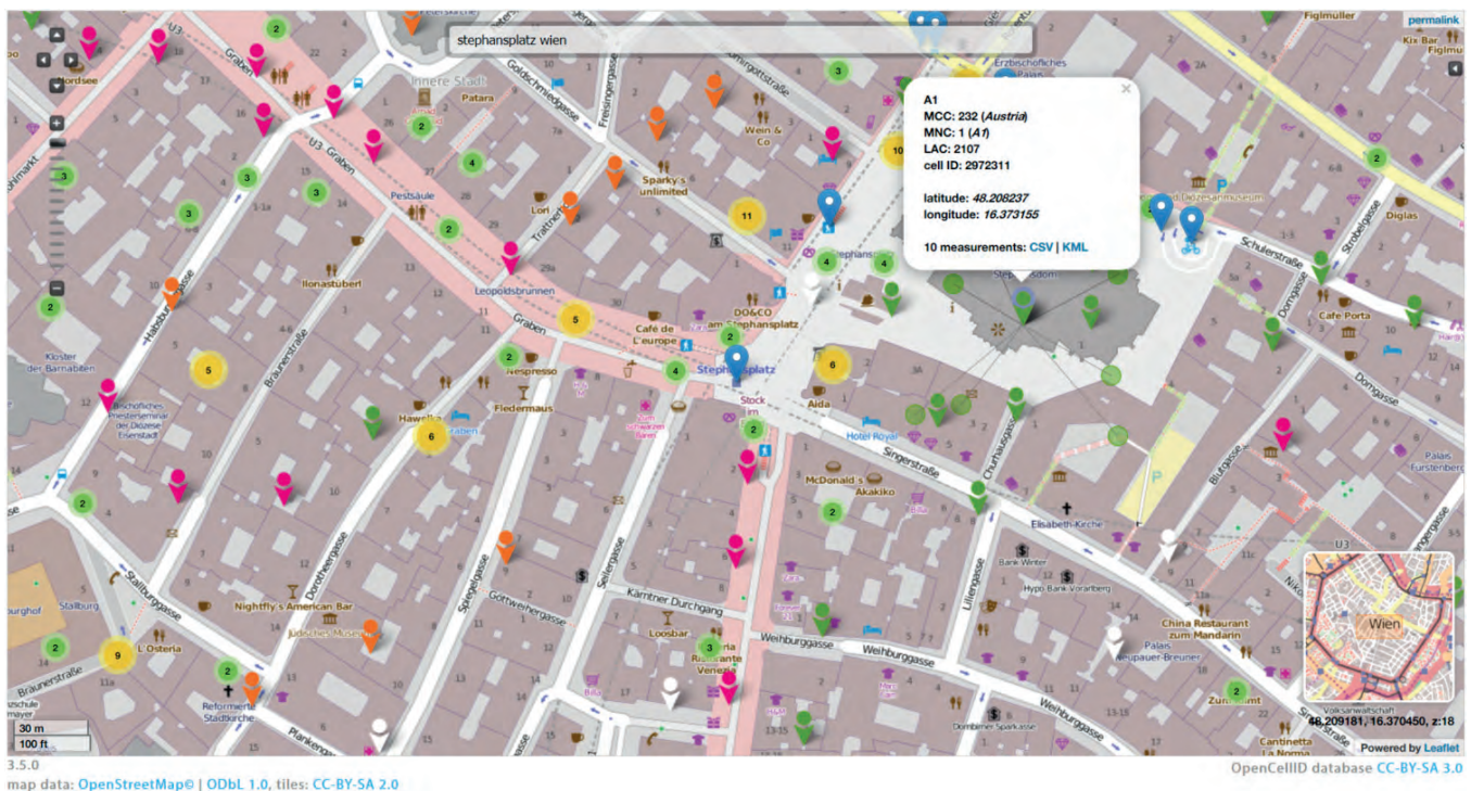
Abbildung 4: Standortbestimmung in OpenCellID mittels Global Cell-ID
